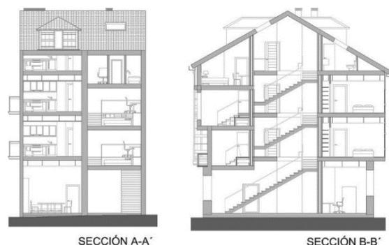
7. Sección transversal y longitudinal del conjunto
